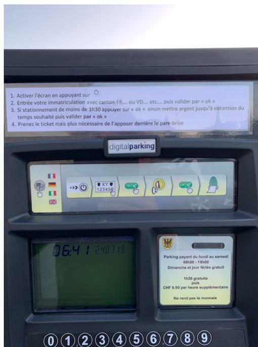
Ces nouveaux appareils demandent d'introduire le numéro d'immatriculation pour enregistrer la procédure de stationnement. Cette méthode permet aux agents de la Police communale de procéder au contrôle de stationnement par scannage des plaques des véhicules.
