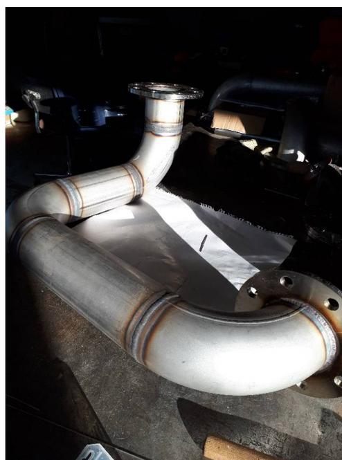
*Façonnage tubulure INOX*
