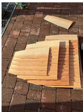
Tavillons terminés et principe de pose
